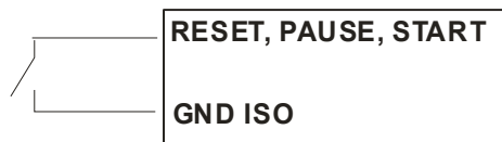
Фиг 2.2. Свързване на входове RESET, PAUSE и START
